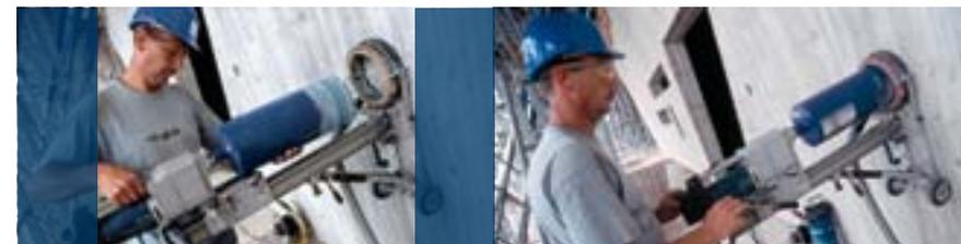
El taladro de diamante GDB 2500 WE Professional perfora con gran potencia y sin sufrir vibraciones a través de hormigón con hierros de armadura.
